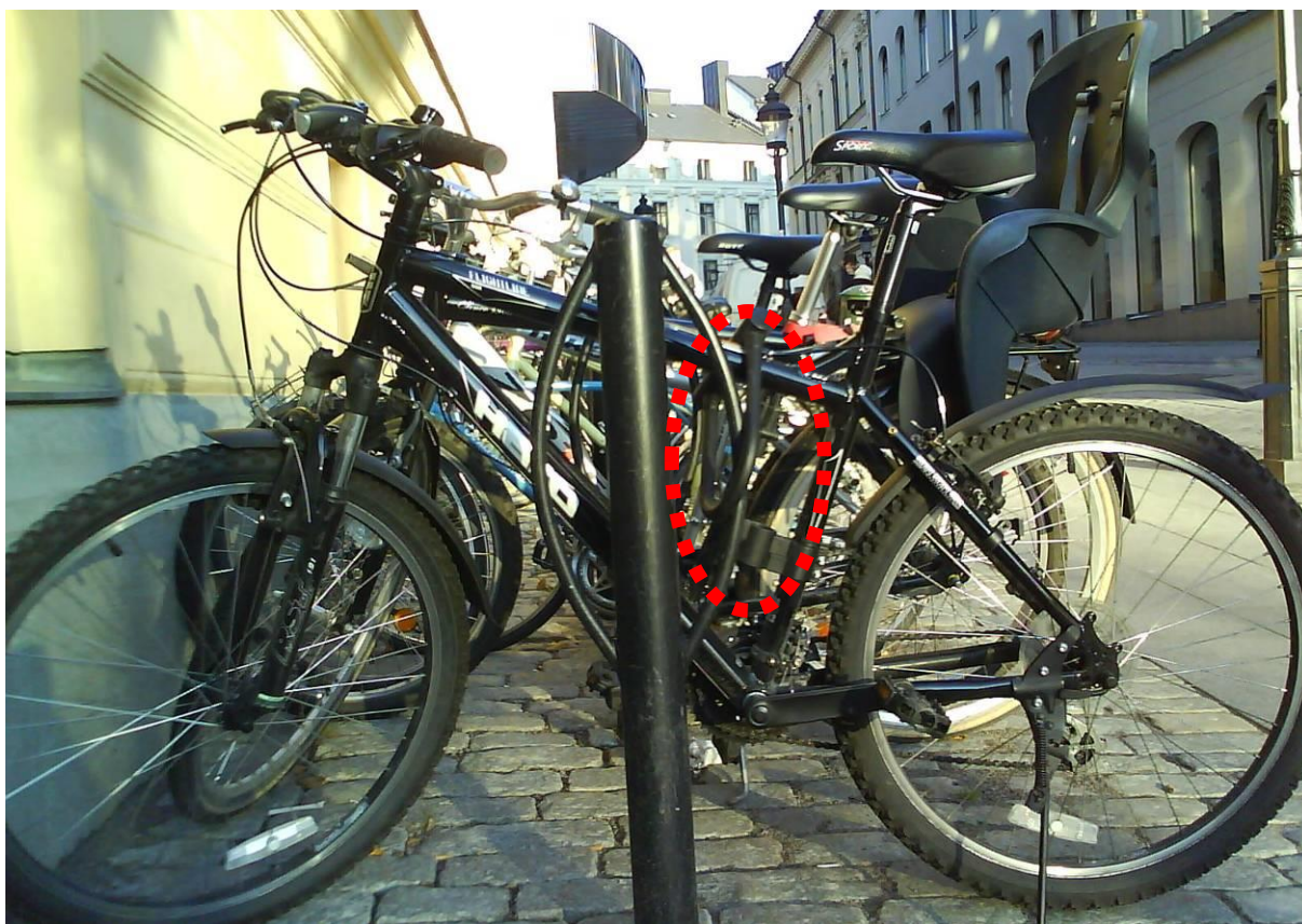
Bild 2.20. För att garantera god stöldsäkerhet bör så kallade ramställ användas så att cykelns ram går att låsa fast i cykelstället. Arsenalgatan, Stockholm.
